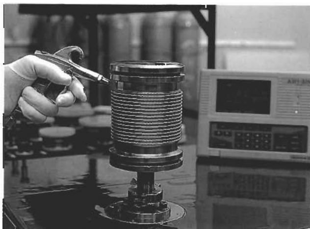
出荷前のヘリウムリーク試験の実施 Helium leak test
